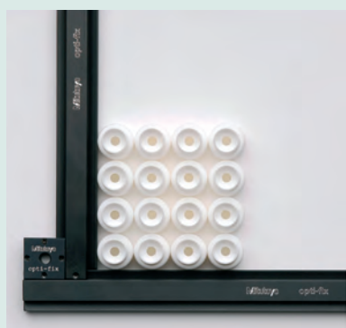
Palettmätning av en sats identiska detaljer placerade mot den rätvinkliga ramen.
