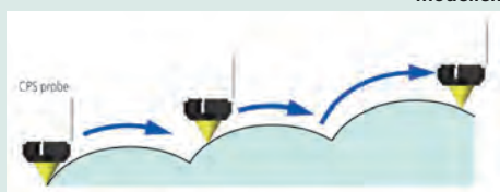
Scannande mätning med automatisk förflyttning i Z-axeln
