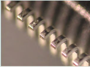
Mätexempel : Höjd på ben på en QFP-kapsel
