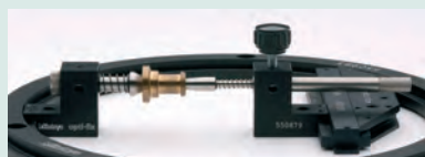
Uppspänning av en cylindrisk detalj mellan spännudubbar.
