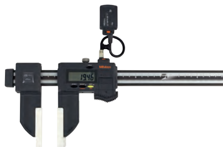
Användning med kolfiberskjutmått
