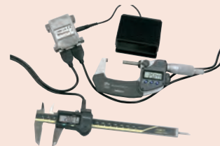
Användningsexempel med fotomkopplare (specialtillbehör)
